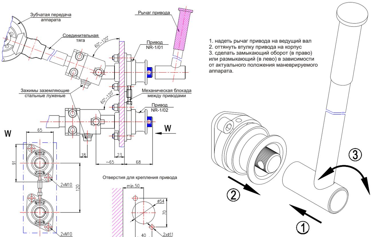
1. надеть рычаг привода на ведущий вал
