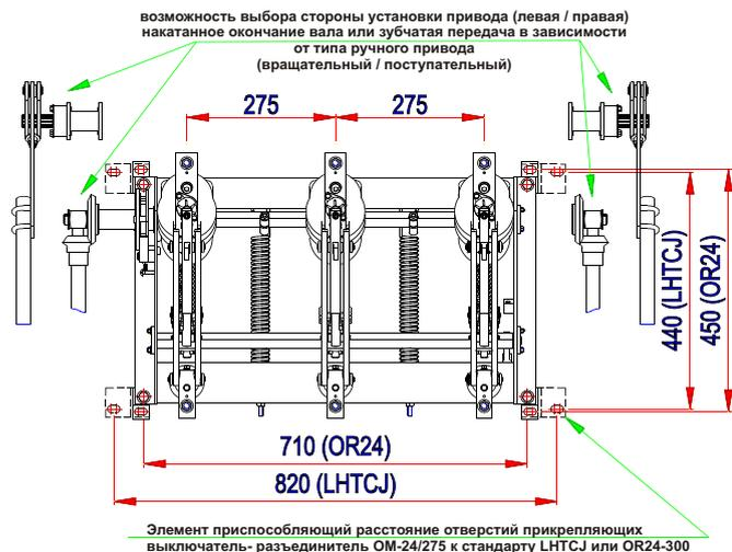
Вид выключателя нагрузки внутренней установки типа OM-24/UD/275
