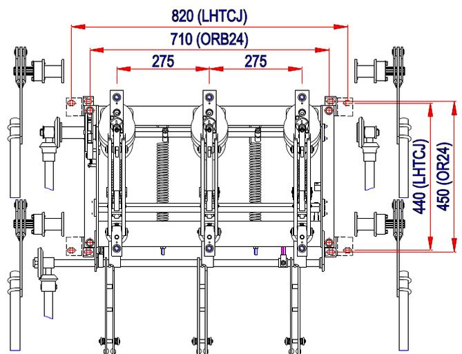
Вид комплекта выключателя нагрузки внутренней установки с предохранителями типа OMB-24/BD/275 - возможности конфигурации:
